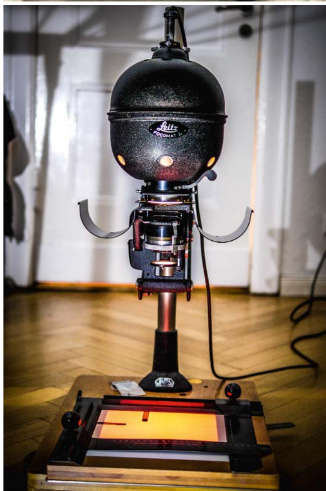
Oben: Auch wenn Robert Capa von Leica auf Contax umstieg, war die M6 das unaufdringliche Werkzeug um dem Geist von 75 Jahren D-Day gerecht zu werden. | Portrait eines Vergrößerers (unten): Leitz brachte den Autofokus-Focomat Ic 1950 heraus. Besonders praktisch sind die Mulden zum verarbeiten von ungeschnittenem Film.
